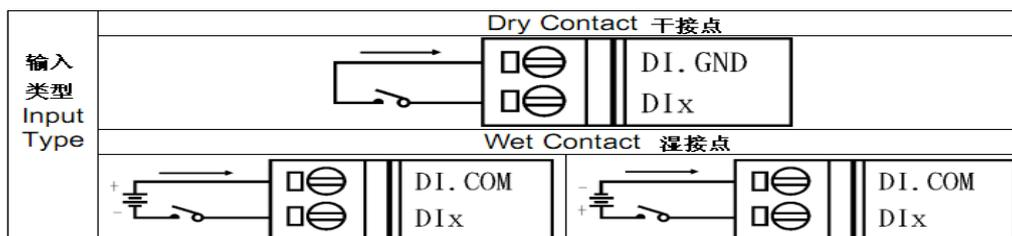
1.3.3 7053 干接点信号输入接线方式:
